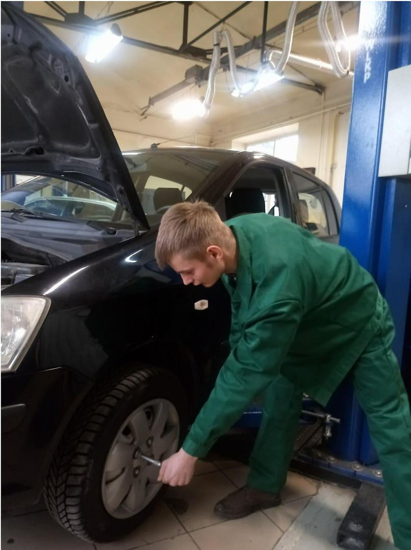
**Gegenstand:** Reifenwechsel, Rad und Reifen identifizieren, Prüfung des organoleptischen Status, Ersetzung eines beschädigten Reifens. Montage und Demontage des Reifens
